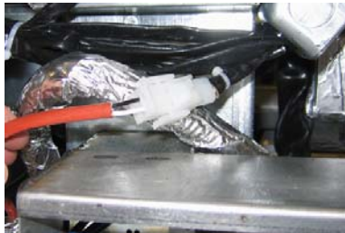
Şekil 6 İki pinli beyaz konnektörü tutturun ve siyah fişi şekilde 6 'da gösterildiği gibi buata takın. * Siyah fişin takılma yerinin resimdeki farklı olabilir.
